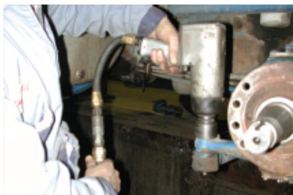
Photo 2. Mécanicien resserrant un embout de direction avec une clé à chocs. Courtoisie de : Ressorts d'autos-camions Rock.
